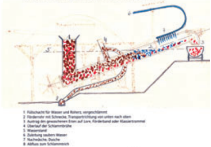
Schematische Darstellung der Wirkungsweise des Siebel-Freygang-Apparates
